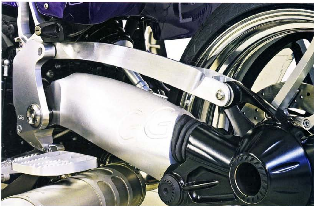
Grüters Lieblingsmaterial ist gefrästes Aluminium. So ist etwa die Einarmschwinge eine Skulptur
