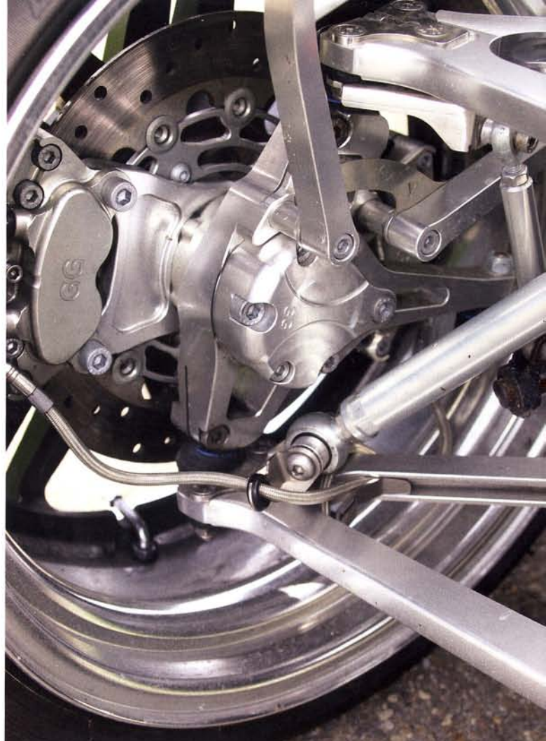
Skulpturen aus gefrästem Aluminium bilden Vorderradaufhängung und Bremse.
