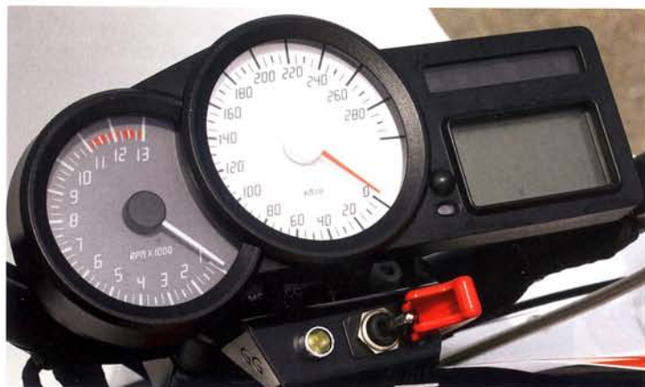
Original-Instrumente von BMW; mit dem roten Kippschalter wird der Rückwärtsgang aktiviert.
