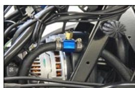
15.71041.00 Oeltemperatur-Anzeige-Kit ermöglicht das Ablesen der Oeltemperatur am Armaturenbrett
