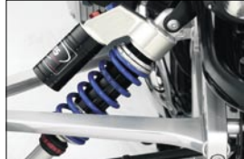
15.71021.00 Federbein mit Zusatzbehälter Zug und Druckstufe einstellbar
