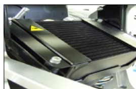
15.71040.00 Zusatz-Oelkühler sorgt für tiefere Oeltemperatur
