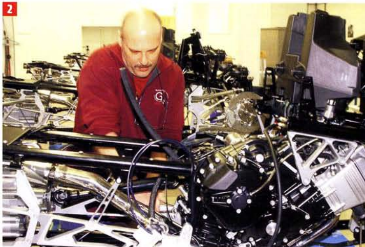
1 Die Rückspiegel liegen ausserhalb des Blickfeldes, und einen weniger zerklüfteten Knieschluss hätten wir uns auch gewünscht – aber was für eine Augenweide! 2 Montage in Ballwil LU: Die Quadster werden in Sechserserien zusammengebaut.
